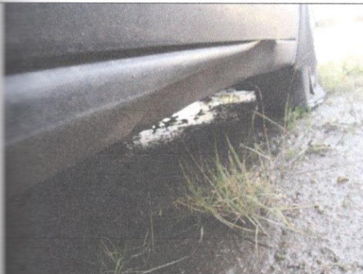
Порог правый-деформация более 50% с НРЖ-замена, окраска
