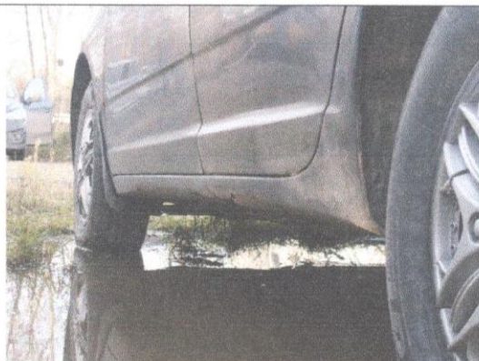
Порог левый-Деф. до 20%-ремонт 2,5нч, окраска
