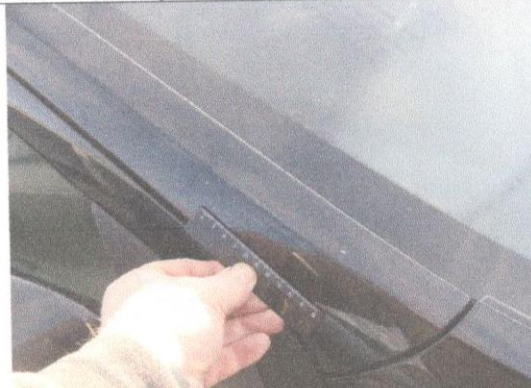
Панель боковины левая-НЛКП в р-не ветрового стекла в виде царапин-окраска
