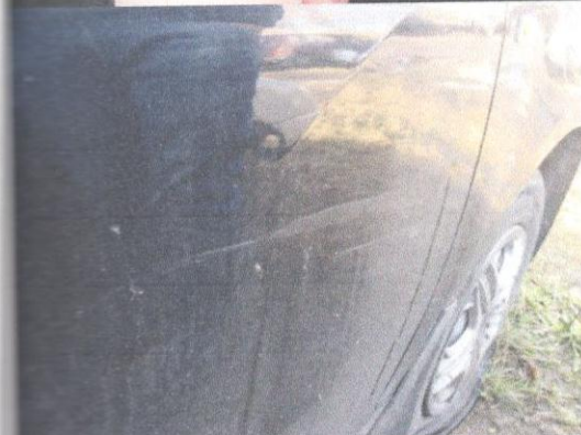
Передняя правая-деформация в передней части с обр. вмятины до 10%-1нч ремонт, окраска
