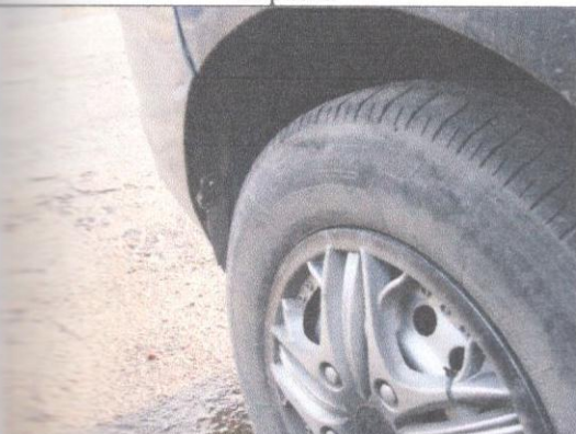
Брызговик задний правый-излом-замена
