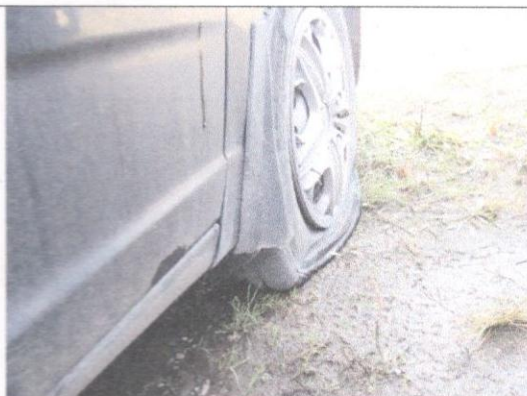
Брызговик передний правый-излом-замена
